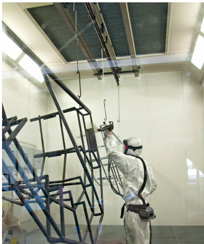
Für die Lackierung müssen Unternehmen optimale Voraussetzungen schaffen, die Anlagentechnik DIN-konform betreiben und u.a. Lüftungstechnik oder Lacklager regelmäßig überprüfen. Quelle: Redaktion
